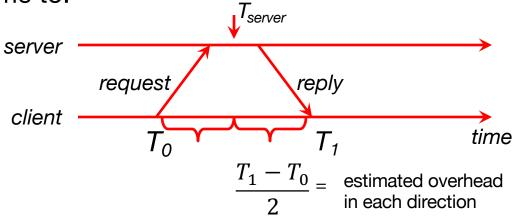
$$T_{new} = T_{server} + \frac{T_1 - T_0}{2}$$
